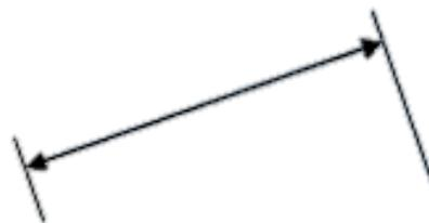
comando constrói cotas alinhadas mostradas abaixo. Usado cota não for nem horizontal, nem vertical.
